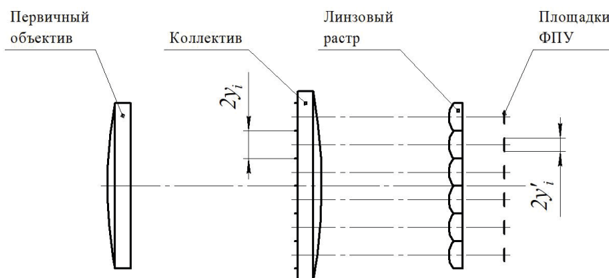
Рис. 1. Оптическая схема приемного канала макета ЛЛС
