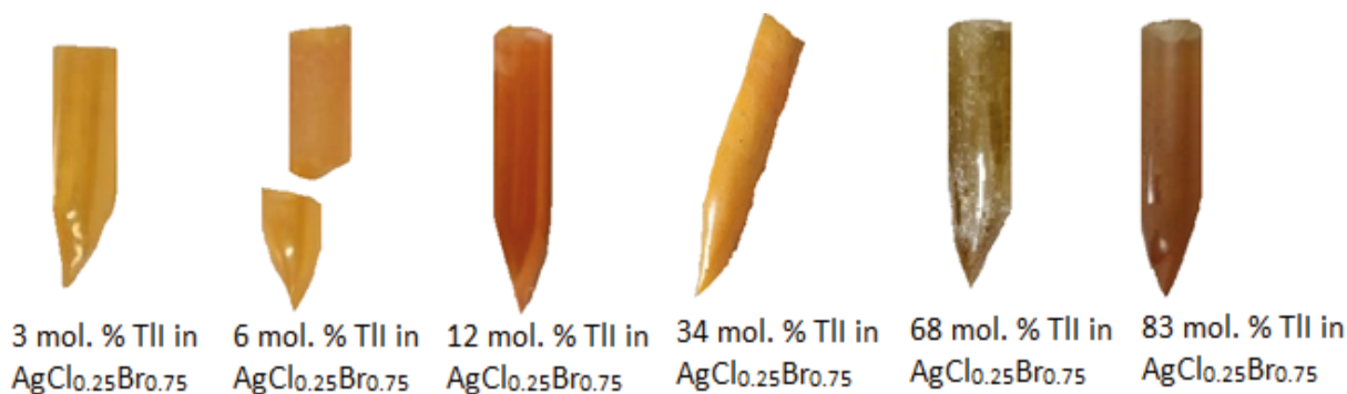
Рис. 1. Внешний вид синтезированных образцов оптической керамики
