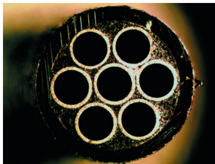
Рис. 1. Полированный торец зонда
