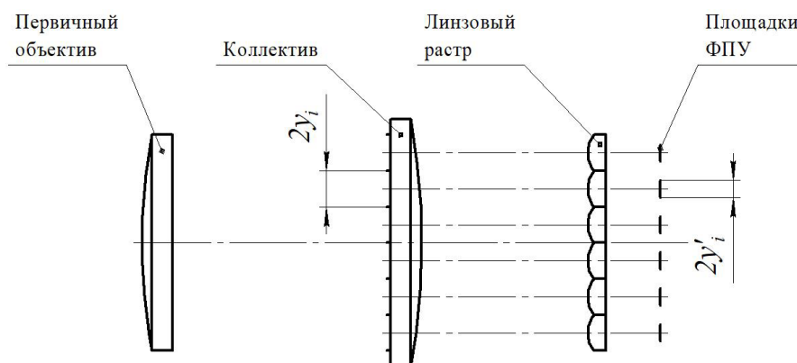
Рис. 1. Оптическая схема приемного канала макета ЛЛС
